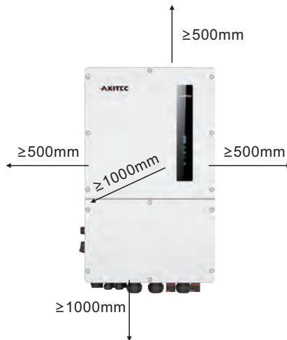
Abbildung 3.5 Montageabstände des Wechselrichters
