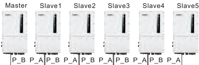
Abbildung 3.23 Parallelschaltung von Klemmen
