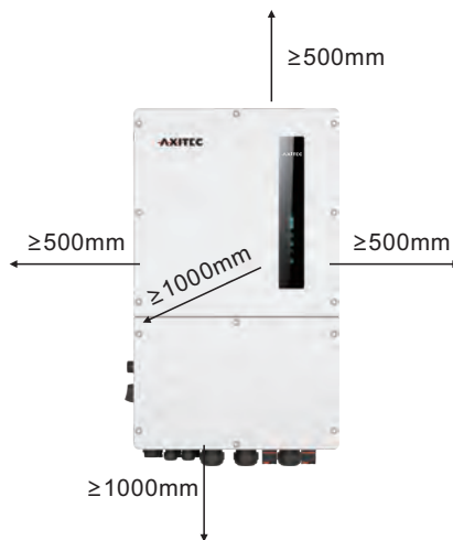
Abbildung 3.5 Montageabstände des Wechselrichters
